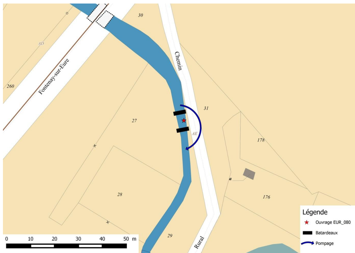
Principe de mise en assec de la zone de travaux
